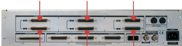
*Inputs 1 – 8    Inputs 9 – 16    Inputs 17 – 24*
